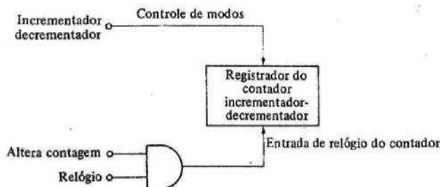
Fig. 8.2-3 O registrador do contador incrementará ou decrementará sua contagem, dependendo do nível lógico do controle de modo, se o terminal "Altera contagem" for mantido em lógica 1 na duração de um ciclo de relógio.
