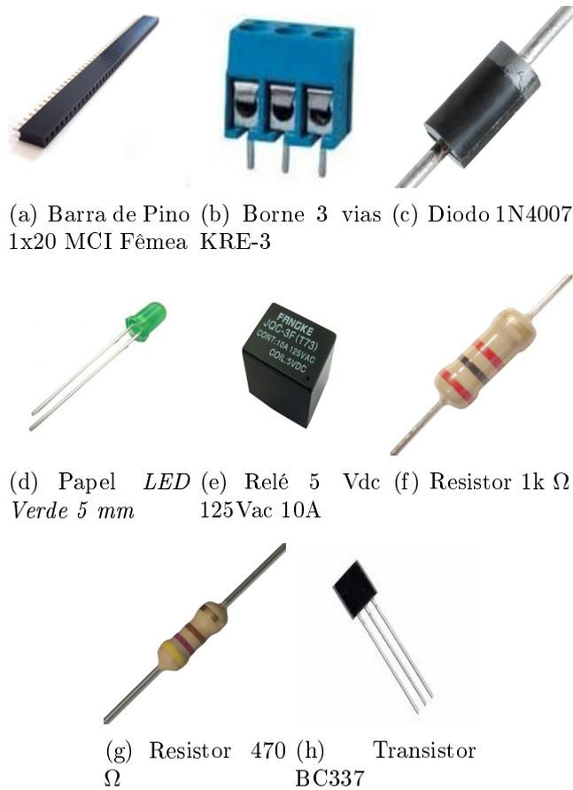
Figura 2: Imagem dos componentes necessários para confecção do módulo relé
