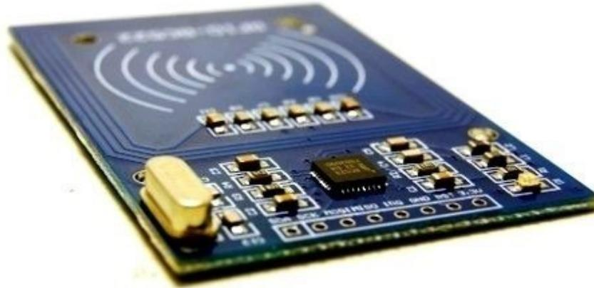
Figura 8: Módulo RFID
